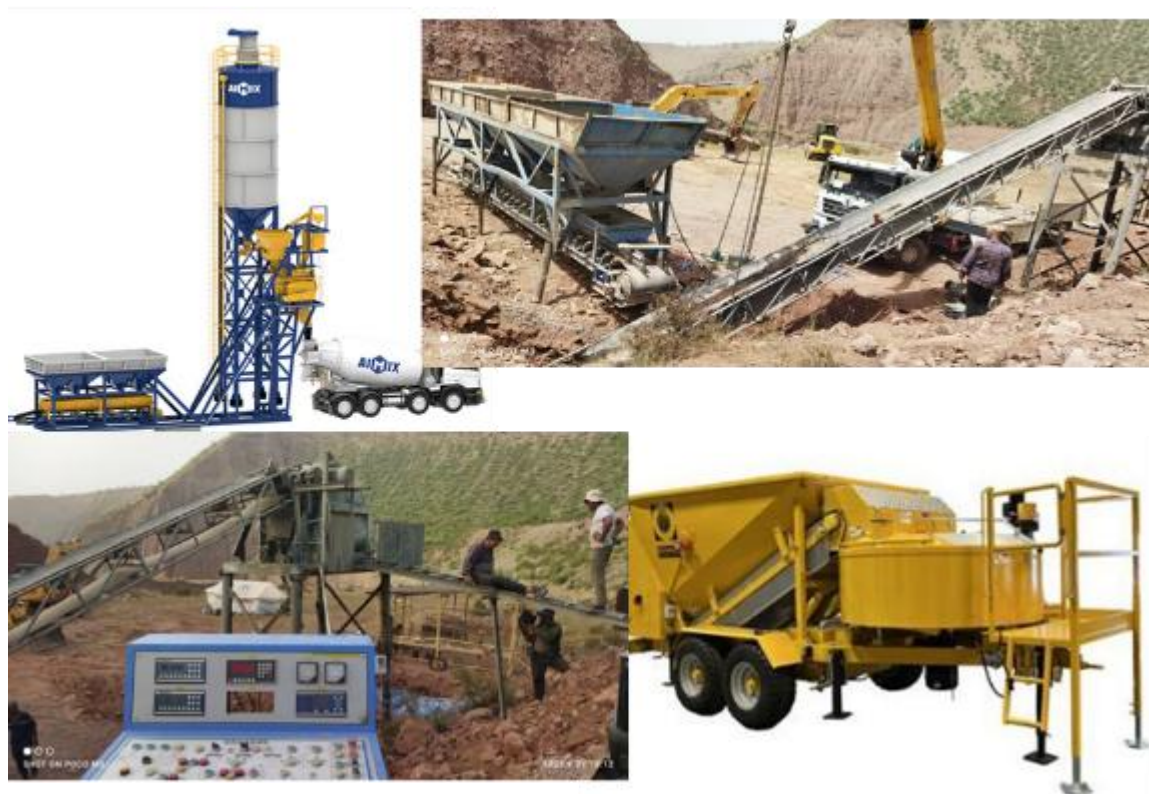
Рисунок 12. Типовые небольшие бетонные заводы
